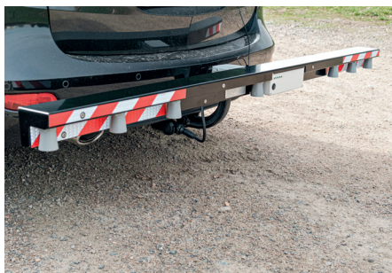
Abb. 2: iFOS-Wegemesslanze v.3.0, mit sieben Ultraschallsensoren, sowie integrierter Sensorbox mit Recheneinheit zur Rohdatenerfassung.
